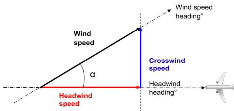
Figura 3: Cálculo do tailwind e headwind, fonte: IVAO
